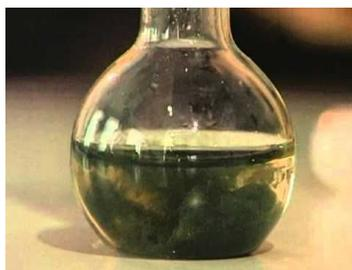
**Вывод:** образец №1 содержит сульфат железа 2, образец №3 содержит сульфат железа 3 т.к. при добавлении раствора гидроксида натрия выпадают осадки соответственно серо-зелёного и бурого цвета
